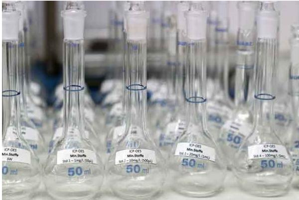
**Abb. 3.6** Elementanalytik – Kalibrierkolben (Quelle: Landesamt für Verbraucherschutz Sachsen-Anhalt)
