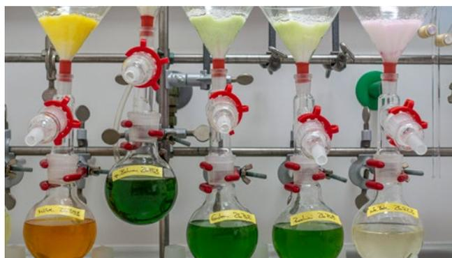
Abb. 3.2 Pestizidlabor – Aufreinigung (Quelle: Landesamt für Verbraucherschutz Sachsen-Anhalt)
