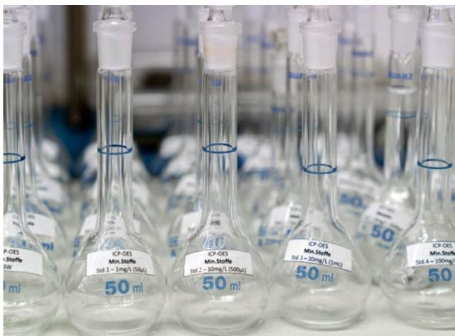
Abb. 3.6 Elementanalytik – Kalibrierkolben (Quelle: Landesamt für Verbraucherschutz Sachsen-Anhalt)
