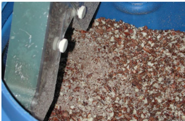
Abb. 3.15 Probenvorbereitung für Mykotoxinuntersuchungen – Zerkleinerung von Nüssen (links) und Nasshomogenisierung (rechts) (Quelle: CVUA Sigmaringen)
