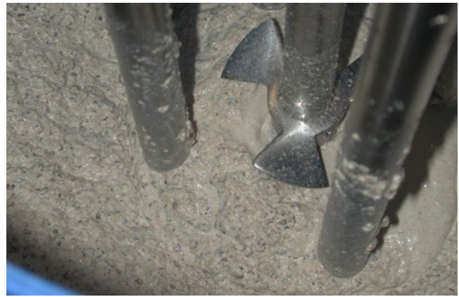
Abb. 3.15 Probenvorbereitung für Mykotoxinuntersuchungen – Zerkleinerung von Nüssen (links) und Nasshomogenisierung (rechts) (Quelle: CVUA Sigmaringen)
